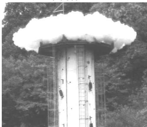
а) срабатывание люка (крышки) в силосе
